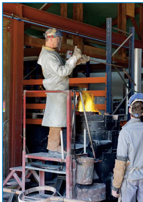
Mise en température du bronze, 1120° précisément
