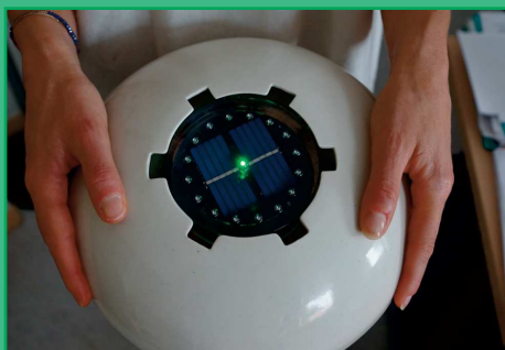
Un prototype de luciole, grandeur nature; il se compose d'un module électronique et d'une céramique faite à la main.
