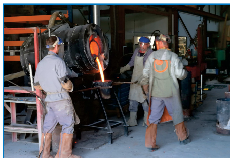
Arrivé à température, le métal est rapidement transporté vers les moules à l'aide d'un creuset
