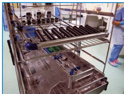
Des raques spécifiques ont été acquises pour le lavage des accessoires du robot chirurgical
